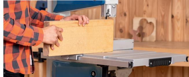
Der beidseitig geführte Längsansschlag garantiert präzise Sägeschnitte. Dieser lässt sich durch den Schnellspanverschluss einfach arretieren.
