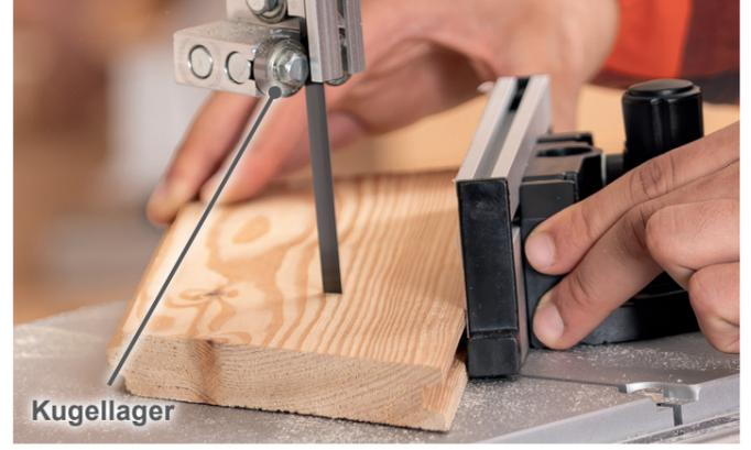
Winkelschnitte sind durch den stufenlos schwenkbaren Säge Tisch einfach und schnell umsetzbar.
